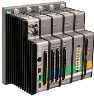
Mit dem modularen Hardware-Konzept lässt sich eine Condition Monitoring-Lösung optimal an unterschiedliche Anforderungen anpassen. Ein webbasiertes Bedienkonzept ermöglicht eine einfache und benutzerfreundliche Konfiguration und Visualisierung.
