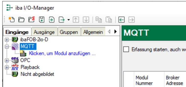
Sind alle Systemanforderungen erfüllt, so wird die MQTT-Schnittstelle im Signalbaum angezeigt.
